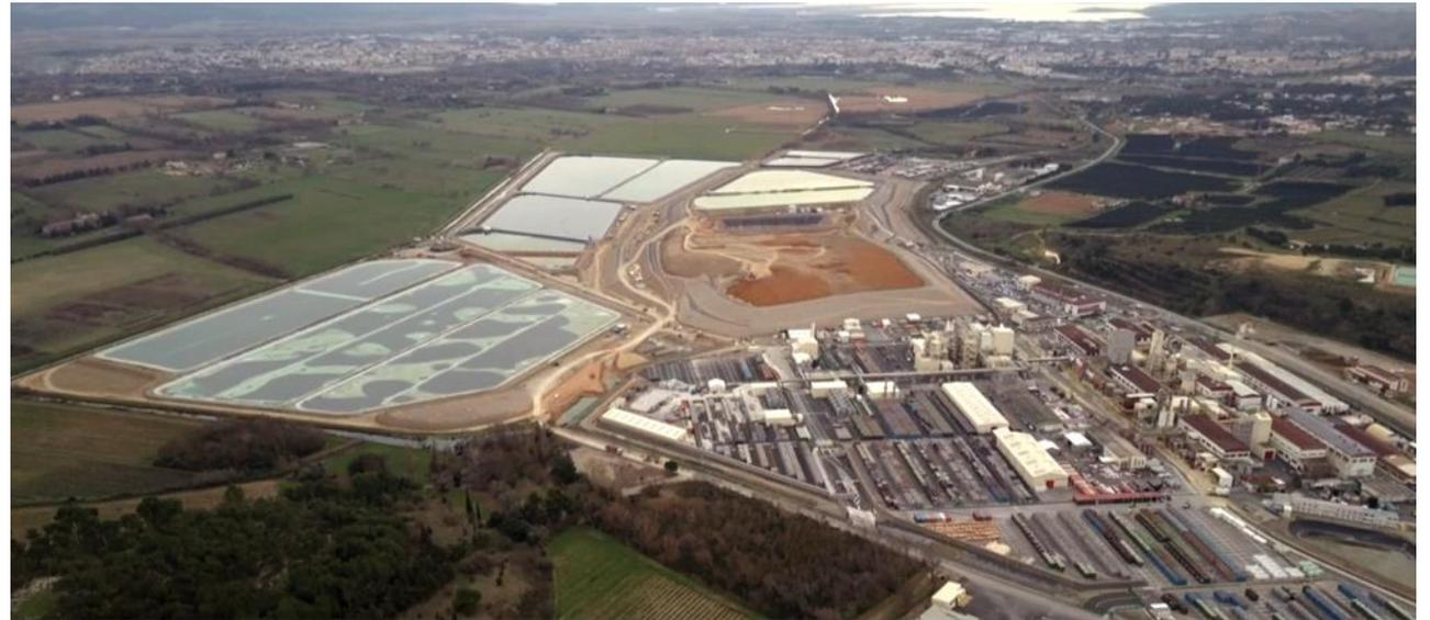
L'usine ORANO de Malvesi avec les bassins d'évaporation des effluents radioactifs dits « nitrates »
