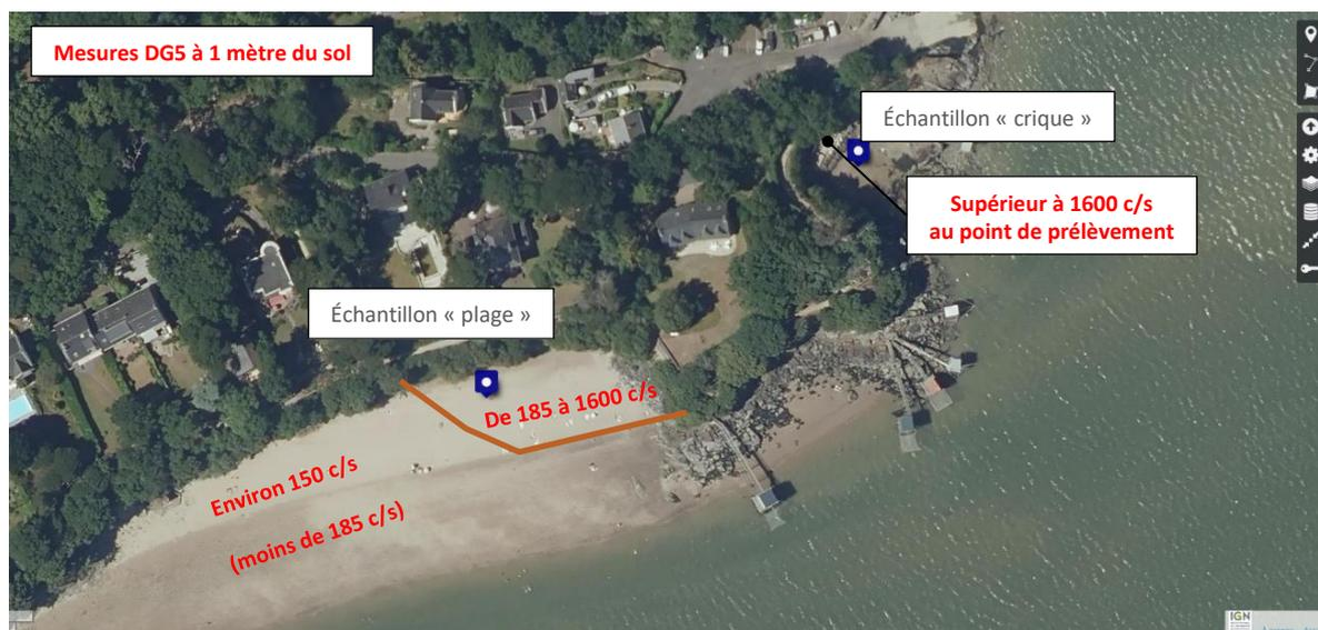
Relevés effectués au moyen d'un scintillomètre DG5 le 29 avril 2022 par M. Jean Max Estay (VPBN)
