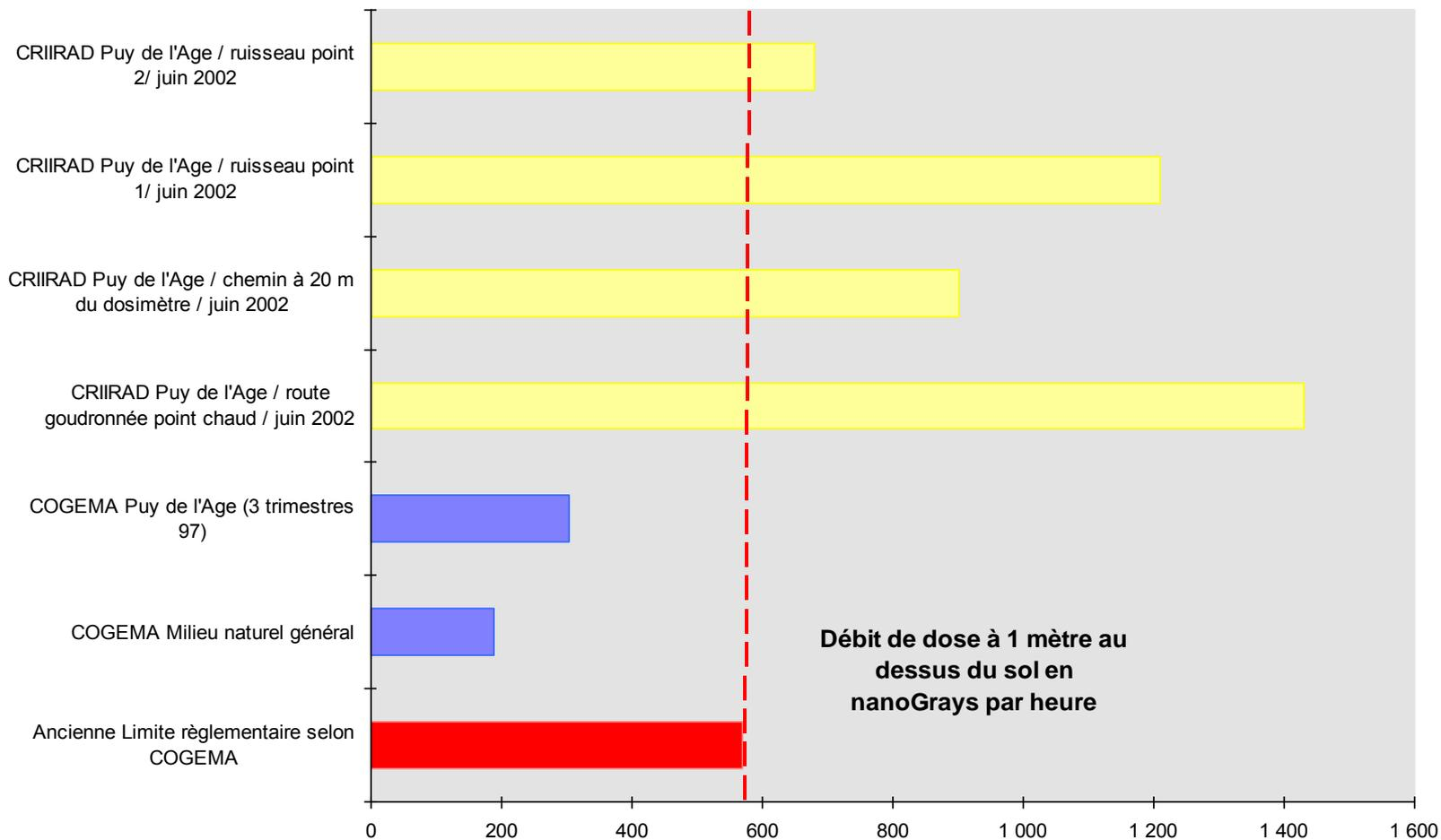
France, Site des Bois Noirs. Dans le cas de cette cour de ferme, le débit de dose atteint  $1,1 \mu\text{Sv/h}$  à 1 mètre du sol au dessus des stériles. Le capteur COGEMA-AREVA qui mesure les radiations est à 100 m de là en un lieu où le niveau de rayonnement est normal
