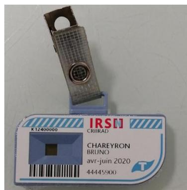
Exemple de dosimètre passif avec système d'attache
