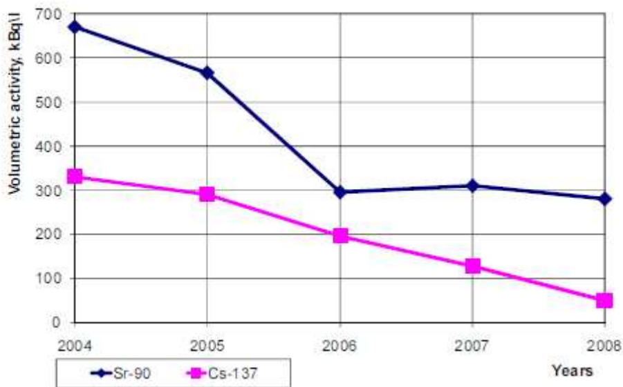
C4 / Variation de l'activité volumique du strontium 90 et du césium 137 (kBq/l) dans l'eau du réservoir R-17 entre 2004 et 2008 [MOK 1]
