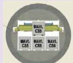
Placement d'un colis de stockage par le pont stockeur sur le niveau 2
