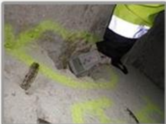
Appareil : Radiamètre Radiagem 2000 Mesure : 0,1 \mu\text{Sv/h}
