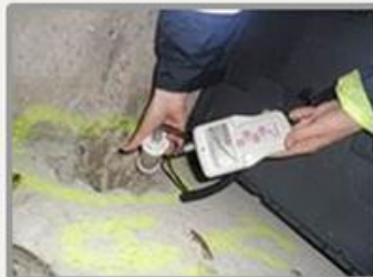
Appareil : Radiamètre Radiagem 2000 avec sonde gamma SG1 R Mesure : 0,115 \mu\text{Sv/h}
