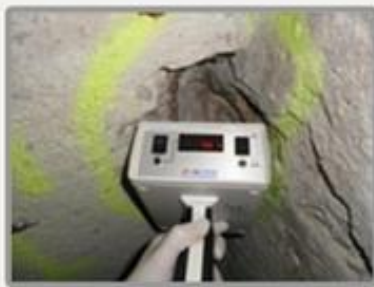
Appareil : Détecteur DG5 Mesure : 100 \text{c.s}^{-1}
