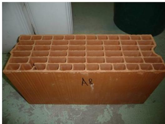
Photographie 14 : brique IMERYS (Optibric PV3+)
