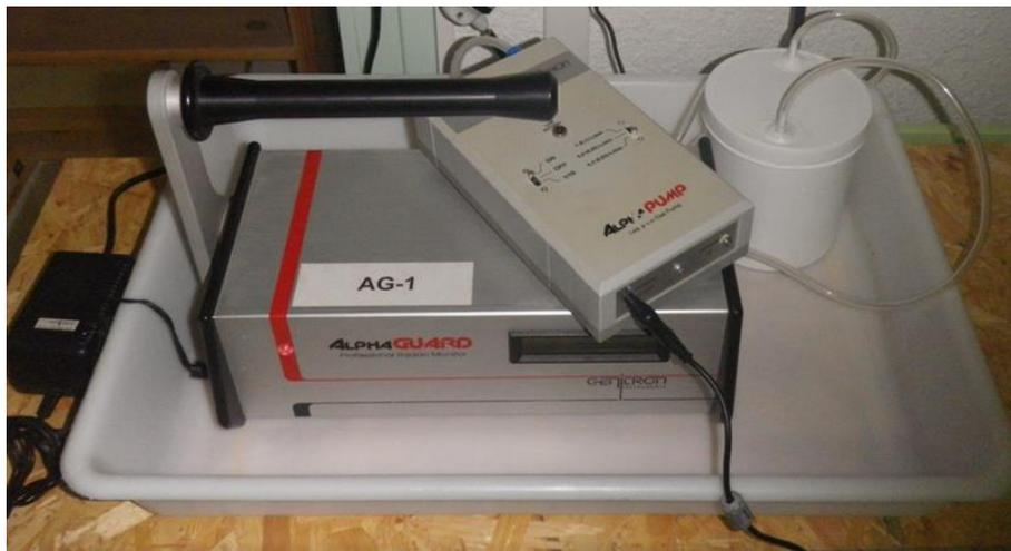
Photographie 16 : circuit de mesure de flux d'exhalation de radon
