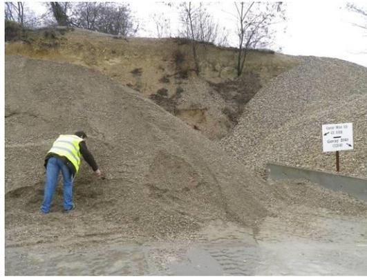
**Photographie 5 : prélèvement de mélange béton**
