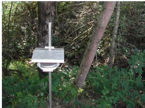
Photo 1 : Station de mesure de radon à proximité de l'exutoire, en pied de digue de retenue des résidus fins de l'usine
