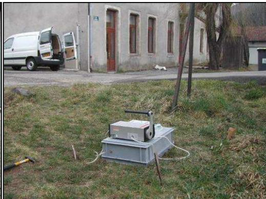
Mesure de flux de radon sur sol extérieur
