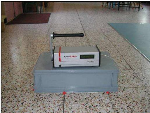
Mesure de flux de radon sur sol intérieur
