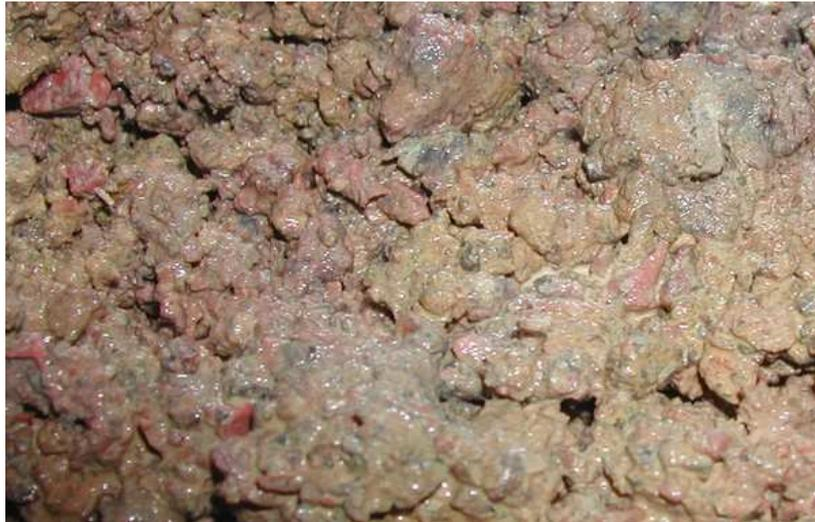
Photo 17 : Coloration rosé des matériaux prélevés dans le sol du stade en bordure du terrain de jeu (strate 40-50 cm)
