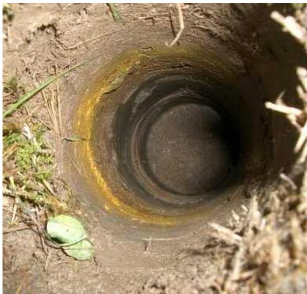
Photo 9 : Parcelle ZI 65 : terrain de l'ancienne usine d'extraction de l'uranium. Couche de matière jaune mise en évidence lors du prélèvement de la carotte E.
