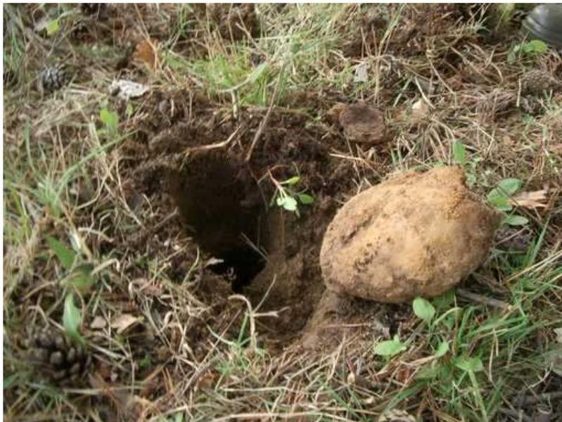
Photo 16 : Terrain Nord Camping : Amas dense de matériaux « actifs » mis en évidence lors du prélèvement de la carotte D.
