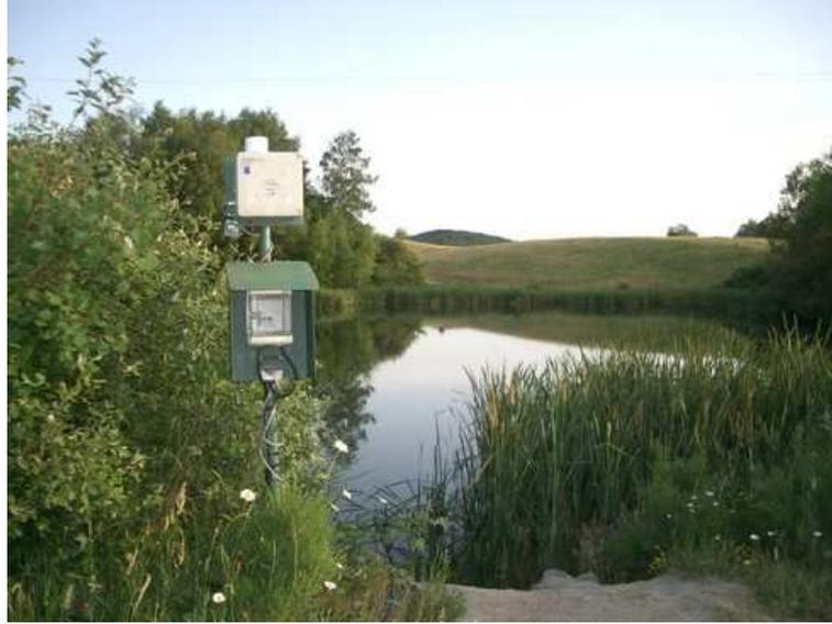
Photo 21 : Dosimètre Algade « Bassin » déplacé des bassins de stockage des résidus fins de l'usine et implanté, depuis le printemps 2004, en bordure de la réserve d'eau suite à des travaux réalisés par la mairie
