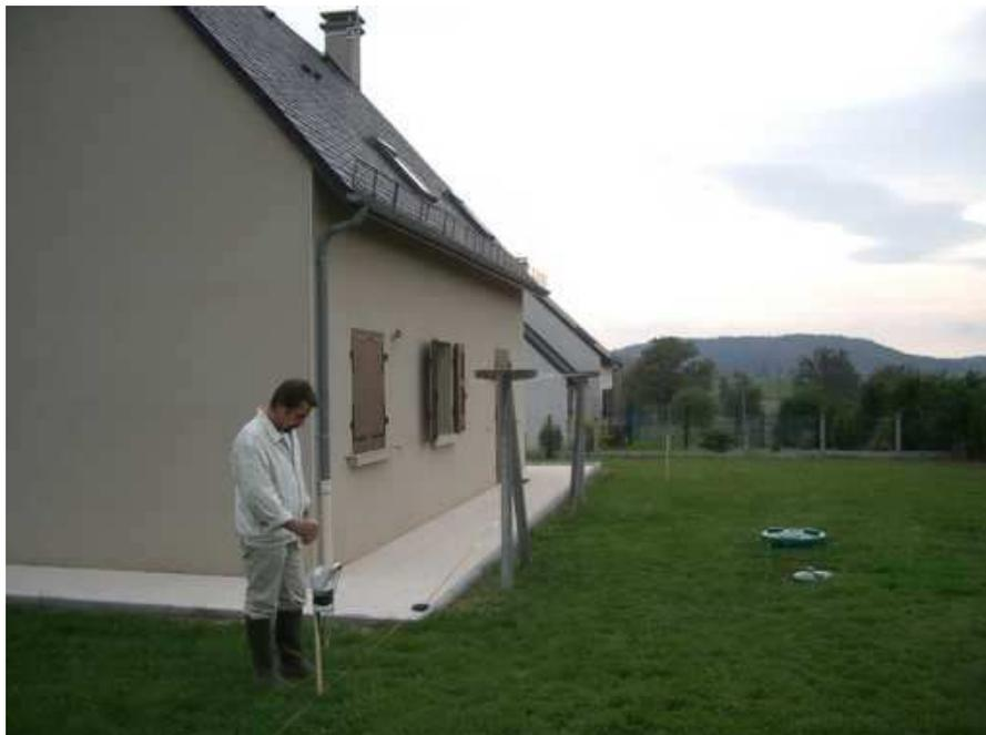
Photo 4 : Mesure de flux gamma à 0,5 m du sol lors de la réalisation du plan compteur sur la partie nord du terrain de la villa centrale.
