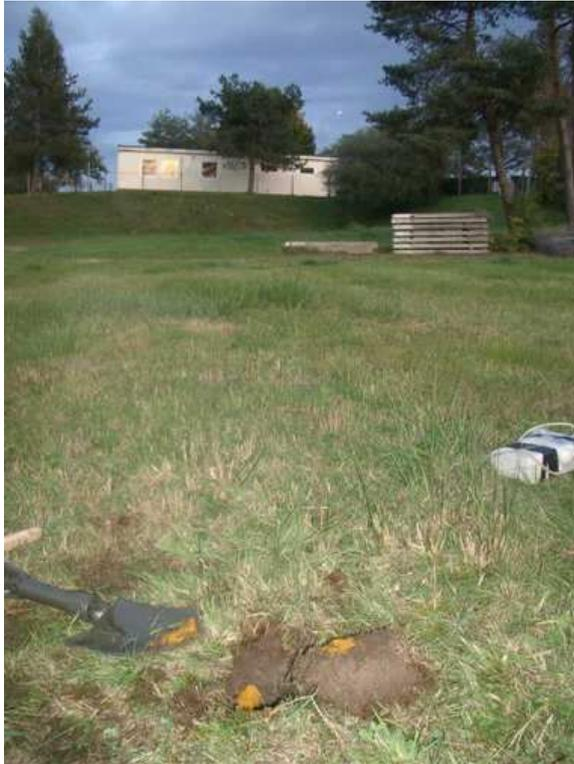
Photo 10 : Parcelle ZI 65 : Matière jaune dans le terrain de l'ancienne usine d'extraction de l'uranium : 2 400 c/s DG5 au contact du sol. En arrière plan ancien bâtiment social, transformé en salle de réunion (ainsi que local technique et sanitaires du camping) sur le terrain du camping municipal.
