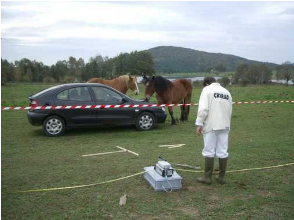
Photo 5 : Zone atelier sur la parcelle ZI 12 : mesure de flux gamma concomitante à une mesure de flux d'exhalation de radon (appareil au centre de l'image). En arrière plan : plan d'eau communal en contrebas de la parcelle.
