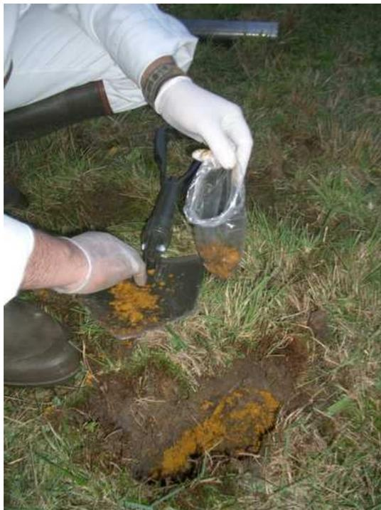
Photo 11 : Parcelle ZI 65 : Prélèvement sélectif de la matière jaune sur le terrain de l'ancienne usine d'extraction de l'uranium (échantillon US MJ)
