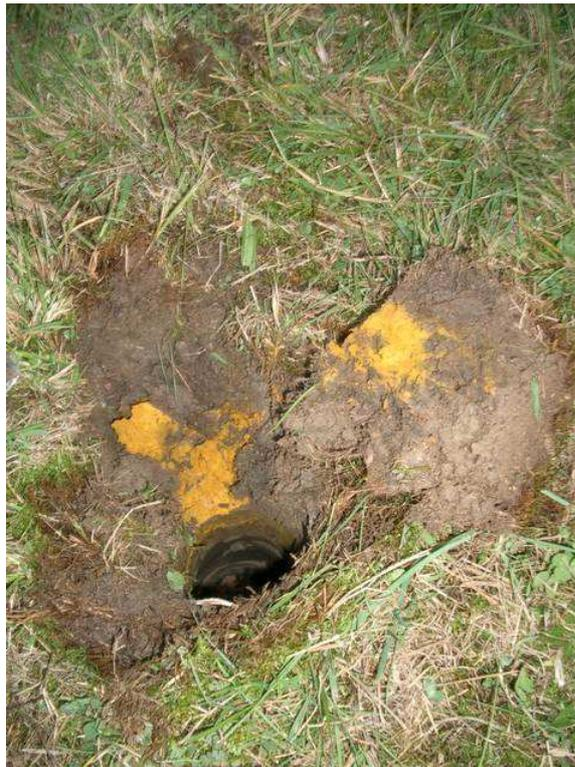
Photo 25 : Concentré d'uranium « Yellow cake » (mis à jour lors du prélèvement de la carotte E) dans les premiers centimètres du sol de la pelouse devant les anciens bureaux (terrain de l'ancienne usine d'extraction de l'uranium).
