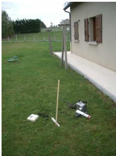
Photo 3 : Point particulièrement actif (point P2 : 1 850 c/s DG5 au contact) sur la pelouse de la villa centrale à 1 m 30 du bord de la terrasse
