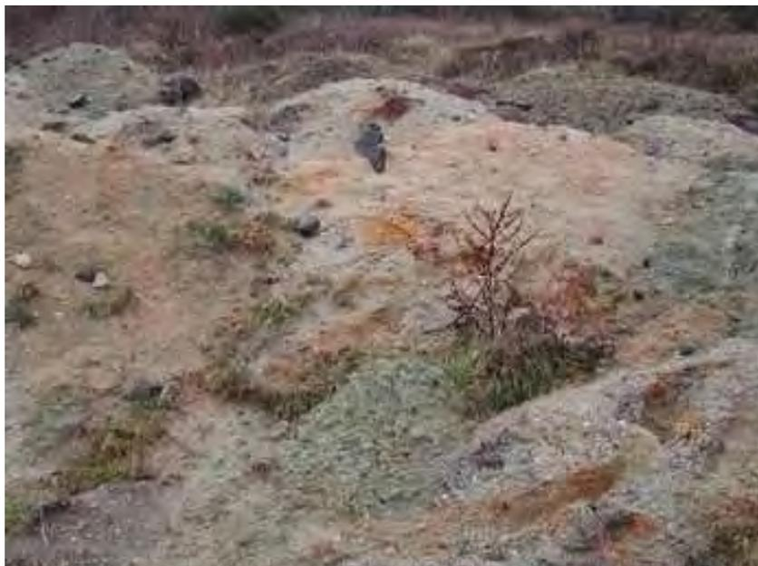
Photo 22 : Monticules de matériaux de curage du lac entreposé sur un terrain en bordure de la route de Chaissac (photographie de mars 2006). Les argiles vertes présentent un niveau de flux gamma au contact plus élevé (250 à 350 c/s SPP2 / 300 à 500 c/s DG5) que les sables ocres (200 à 300 c/s DG5).
