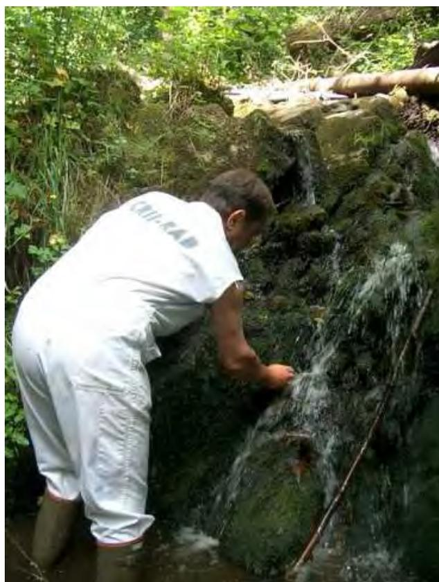
Photo 32 : Prélèvement de mousses aquatiques dans le Rejet Nord en amont de sa confluence avec le Combret
