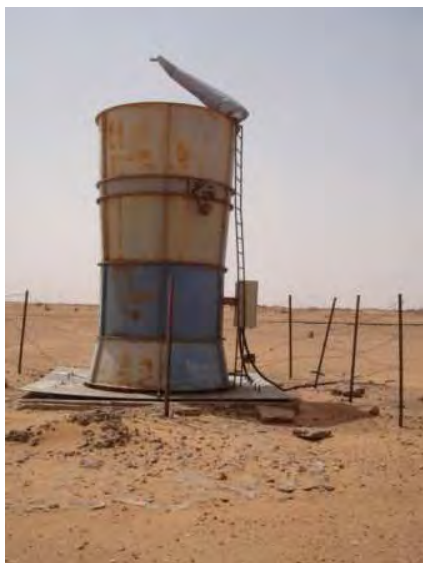
Bouches d'aérage COMINAK (source : C Chamberland et M. Roche, 2007)
