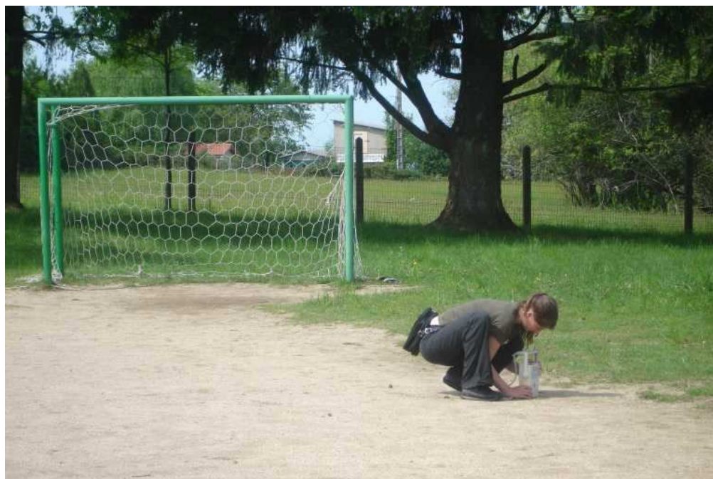
Mesure du flux gamma au DG5 / point chaud à 2 200 c/s au niveau du terrain de foot de l'école le 17 mai 2006
