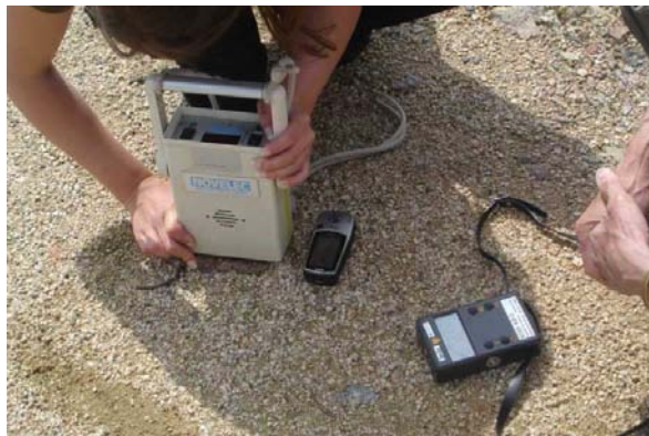
Localisation du point chaud PC1 dans la cour de l'école / mesures de flux gamma (DG5) et débit de dose (radiamètre 6150 AD).
