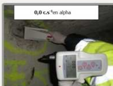
Appareil : Radiagem 2000 avec sonde SAB 100 Mesure : 0,00 \text{c.s}^{-1} sur voie alpha
