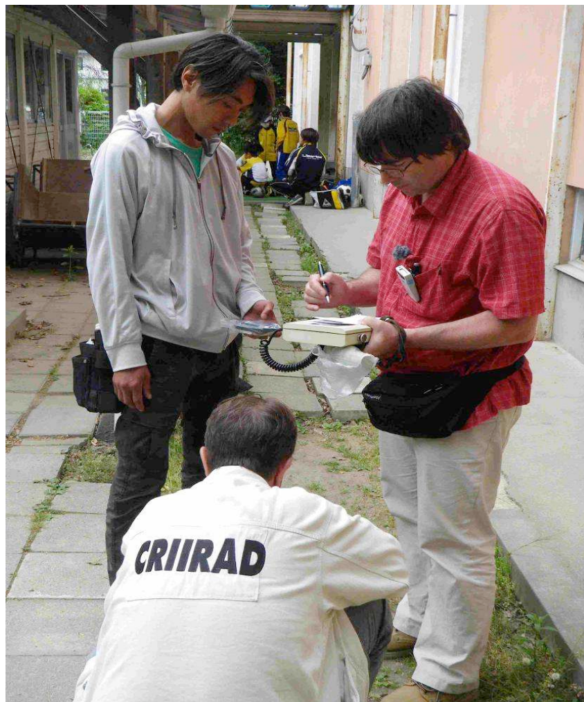
地上1mで放射線量を測定する47プロジェクトの岩田氏とCRIIRADチームのクールボン、シャレイロ ン両氏（測定結果：2 \mu\text{Sv/h} ） 福島市森合小学校・2011年5月26日
