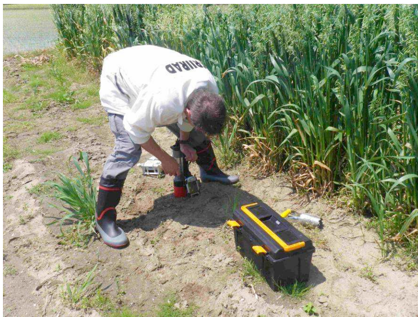
ガンマ分光計を使用してセシウムの蓄積量を測定するCRIIRAD検査技師クリスチャン・クールボン氏 北茨城地域・2011年5月25日
