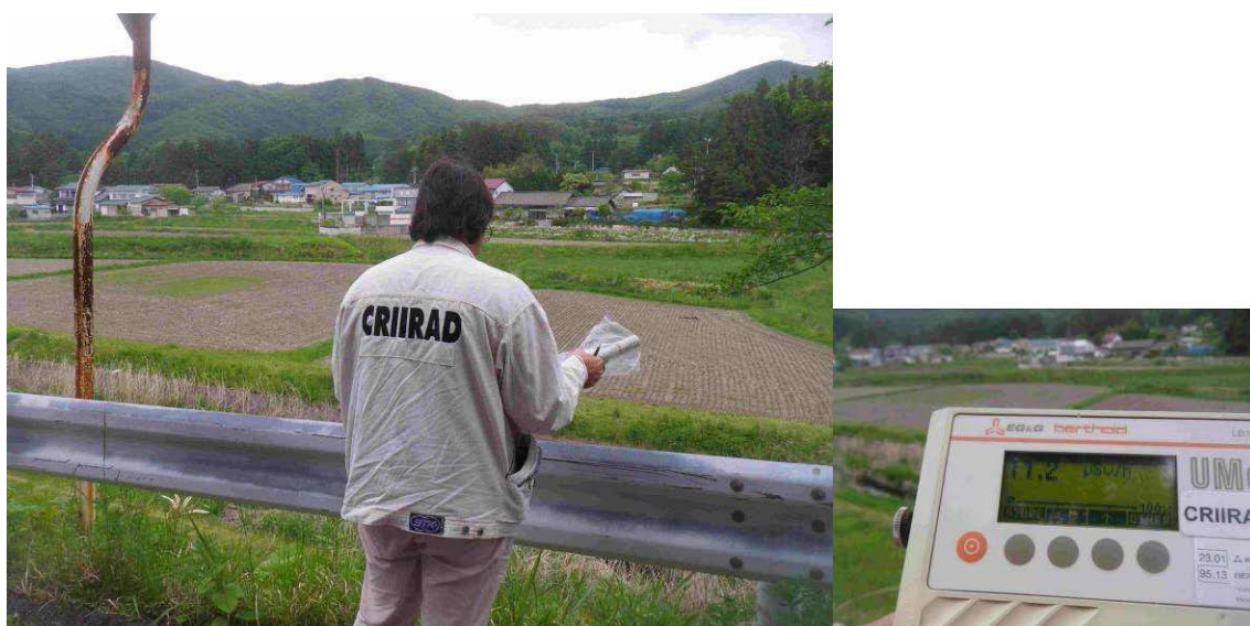
地表1mで放射線量を測定するCRIIRADエンジニア（シャレイロン氏）（測定結果：11.2 \mu\text{Sv/h} ） 飯舘村長泥地区・2011年5月27日
