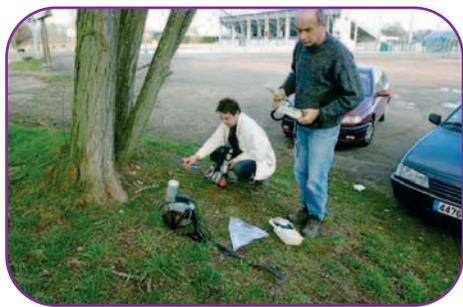
À l'arrière plan, les tribunes, au premier plan, le laboratoire de la CRIIRAD procède à un prélèvement de sol pour analyse sur un emplacement particulièrement irradiant.
