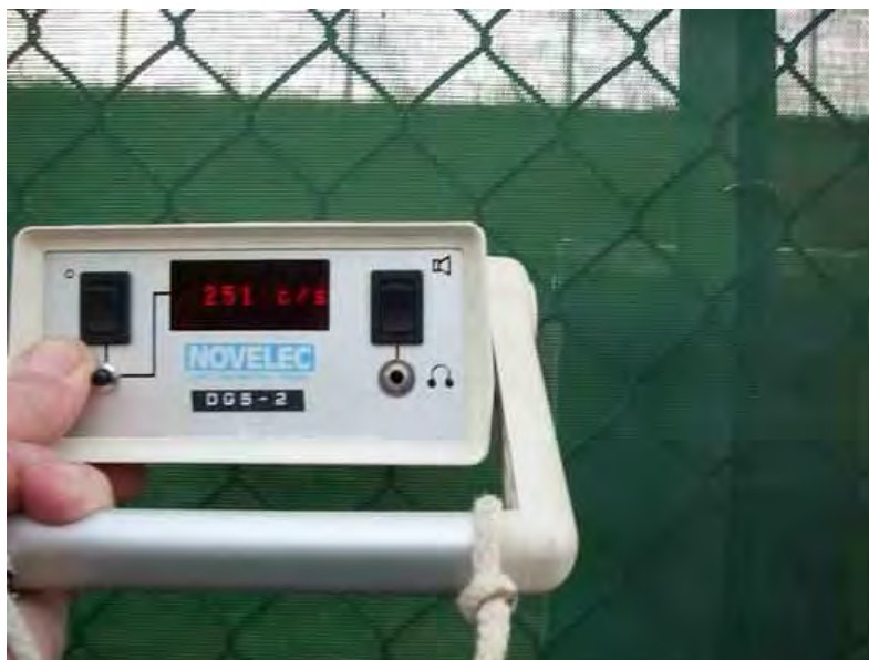
Mesure du flux de rayonnement gamma au point C7, clôture FBFC / CRIIRAD, novembre 2007
