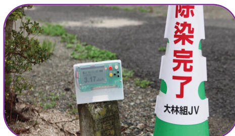
Un coin de la rue de la commune de TOMIOKA-machi qui a été « décontaminé ». Le cône de signalisation précise <Fin de travaux de décontamination> et le nom de l'entreprise. Mais, le radiamètre indique 3,17 microSieverts par heure soit une valeur plus de 30 fois supérieure à la normale (crédit : Shinsu HIDA, février 2016).
