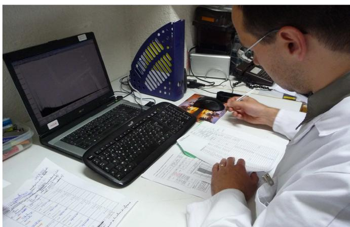
*Ci-dessus **Jérémy Motte**, ingénieur en charge du service « balises », prépare un filtre papier pour l'analyse. Ce type de filtre est utilisé pour le prélèvement des poussières radioactives en suspension dans l'air. La longueur prélevée pour analyse est fonction de la période que l'on souhaite contrôler. Sachant que le filtre avance de 1 cm par heure, les dépôts d'une journée sont fixés sur une bande de 24 cm de long.*
