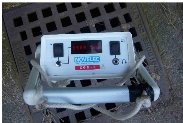
Mesure du taux de radiation au contact du sol (CRIIRAD, 2012)
