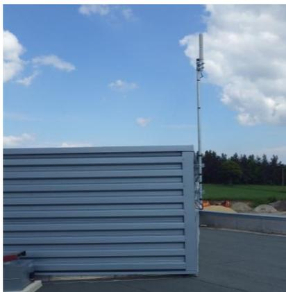
*Sonde gamma implantée sur le toit du bâtiment des services techniques*
