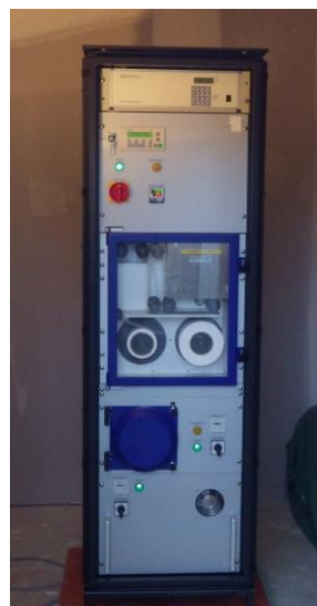
A gauche : Mesure du débit de dose gamma et tête de prélèvement de l'air extérieur
