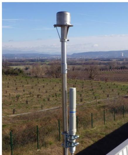
*A gauche : Mesure du débit de dose gamma et tête de prélèvement de l'air extérieur*
