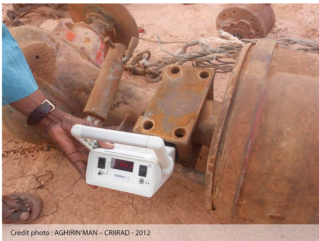
Photo A5 / Niveau de radiation gamma plus de 2 fois supérieur à la normale sur des ferrailles (512 c/s DG5)
