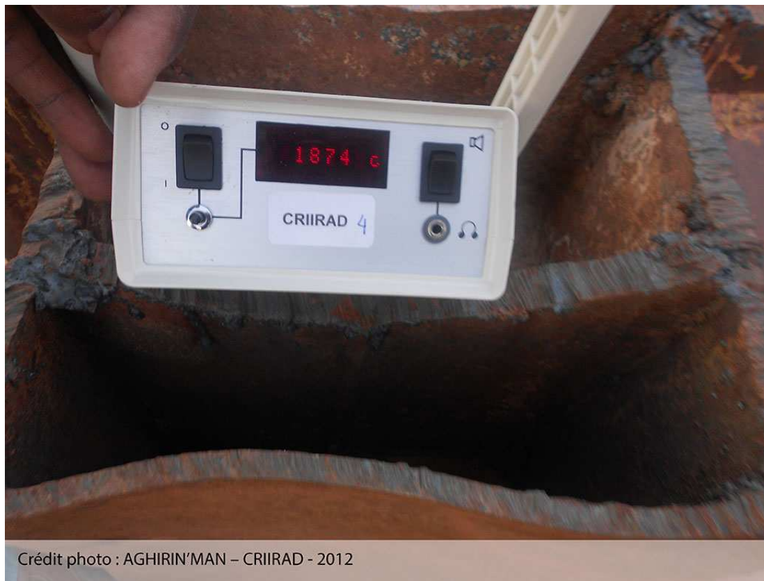
Photo A4 / Niveau de radiation gamma plus de 9 fois supérieur à la normale sur des ferrailles (1 874 c/s DG5)
