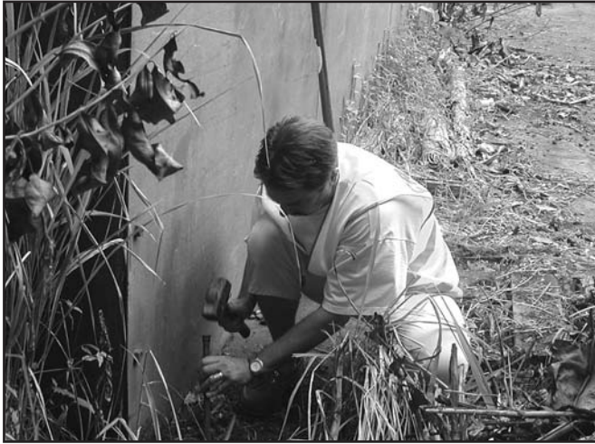
Echantillonnage de fibrociment dans l'ancienne canalisation de récupération des eaux de toiture du blockhaus destiné à protéger les militaires à Taku (Mangareva), le 8 oct. 2005. Epaisseur des murs : 60 cm. © CRIIRAD
