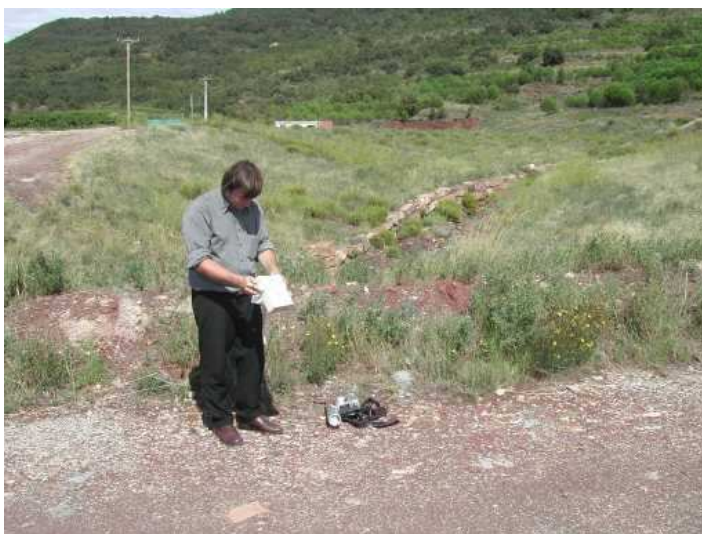
N°4: Présence de fragments actifs sur la piste d'accès au carreau de la mine de Puech Bouissou / Photographie CRIIRAD du 15 septembre 2004 / Flux gamma DG5 au contact du fragment noir : 20 000 c/s DG5. Débit de dose au contact 79 \mu Sv/h et à 1 mètre : 0,56 \mu Sv/h.
