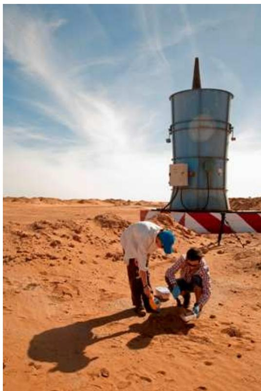
Echantillonnage de sol radioactif près d'une bouche d'aérage
