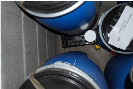
Pose du pot plastique contenant l'eau sans tritium dans la guérite.
